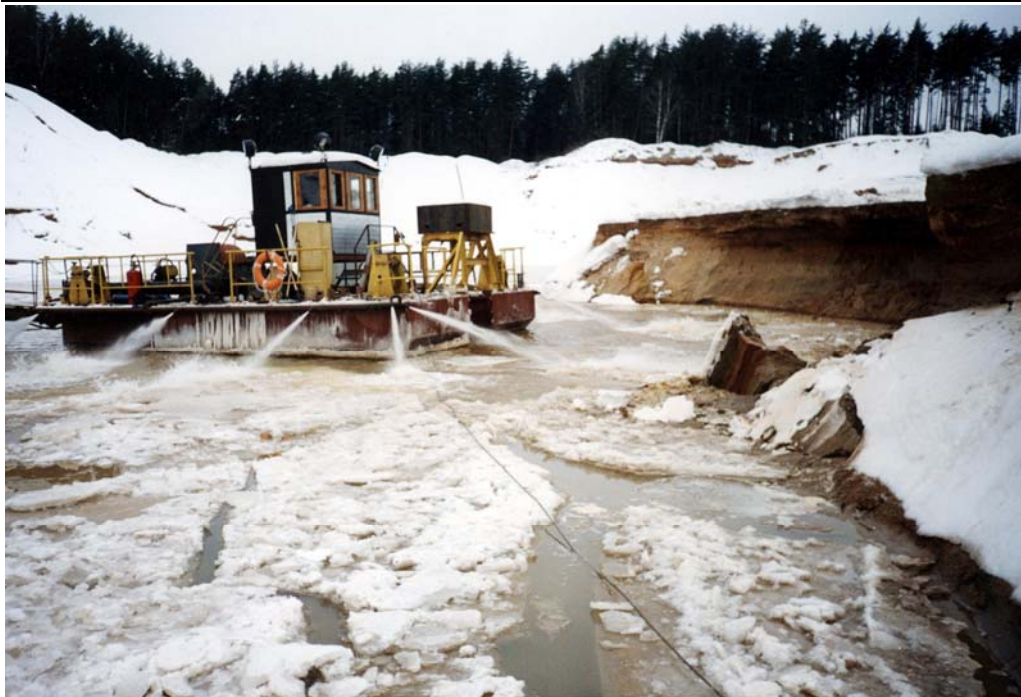
Рис. 2. Добыча в зимних условиях (работа майнообразователя)
