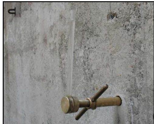
**Фото 2. Определение глубинной водонепроницаемости конструкций в натурных условиях прибором ВБК-1**
