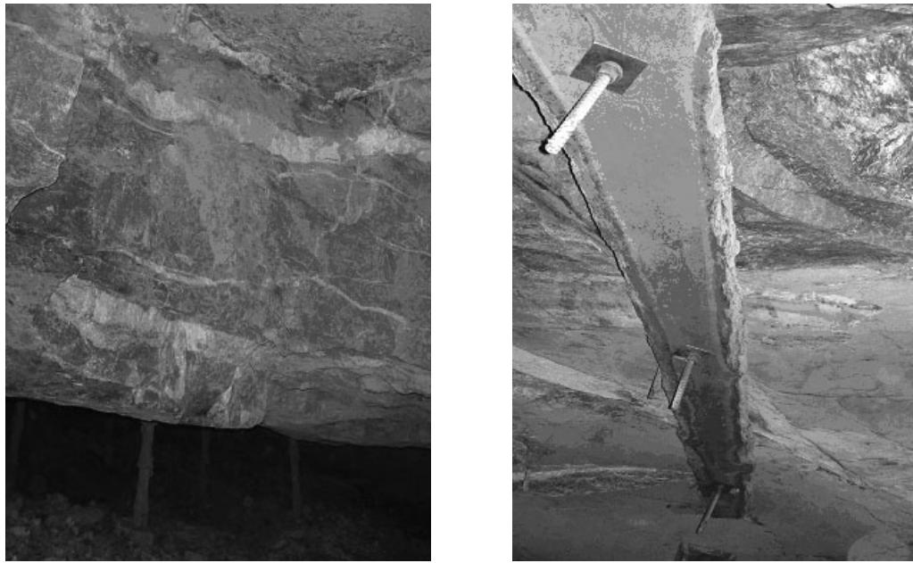
**Рис. 4. Крепление ложной кровли различными видами крепи:** а) -гидростойки; б) – СПАК
