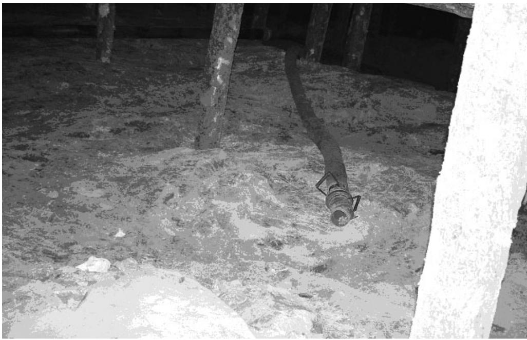
**Рис. 3. Подошва блока после зачистки. Всасывающая форсунка**
