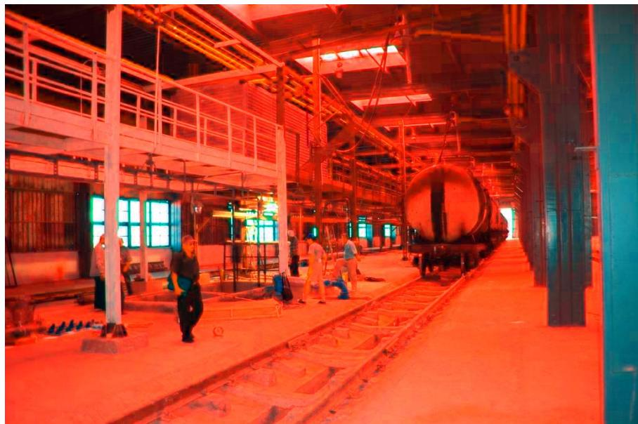
**Рис. 1. Стационарная промывочная станция с использованием модуля МКО-1000**
