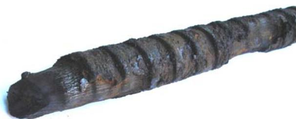
коррозионное разрушение элементов анкерной крепи.
