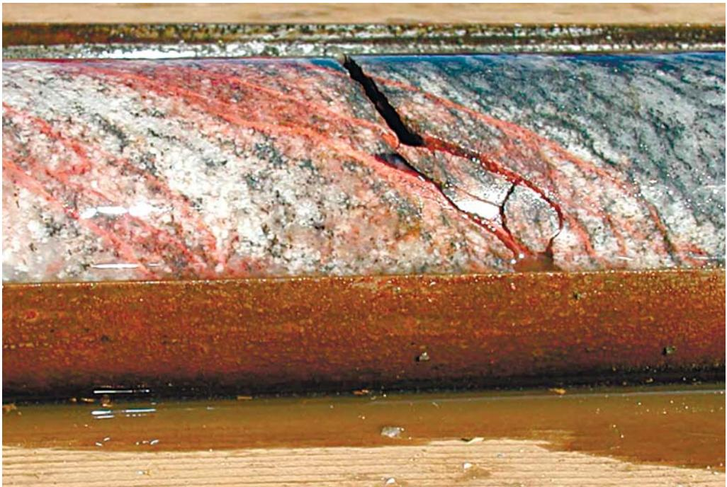
**Рис. 4. Образец керна из системы ССК 76-3**
