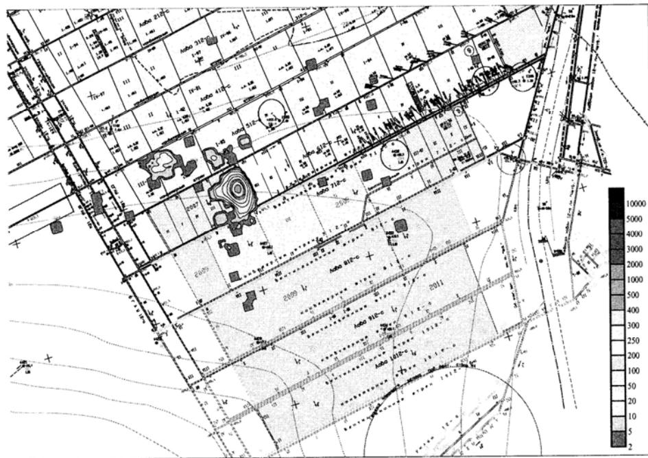
**Рис. 4. Пример построения карты прогноза удароопасного состояния массива**
