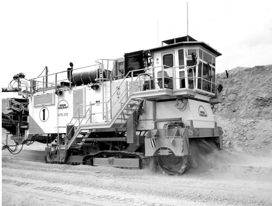
Рис. 2. Карьерный комбайн MTS 250 на разработке продольного пласта Джерой – Сардаринского месторождения фосфоритов
