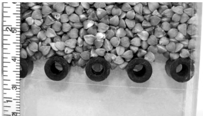
Рис. 4. Структура прямых (в центре) и обратных сводов угловатых частиц над щелевыми отверстиями гравитационной решетки
