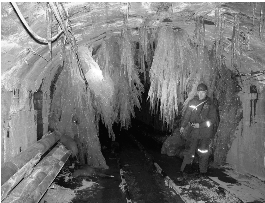
Рис. 1. Общий вид воздухоподающей выработки при ее обледенении, температура +4 °С
