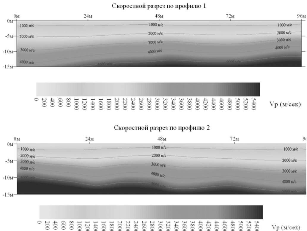
**Скоростные разрезы по профилям 1 и 2, подготовляемых к взрыву блоков, полученные методом сейсмометрии**
