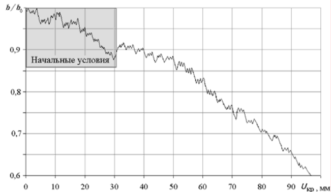
Рис. 1. График фрактальной функции \tilde{g} изменения размеров блоков пород разрушенного контура заанкерванной кровли от её смещений
