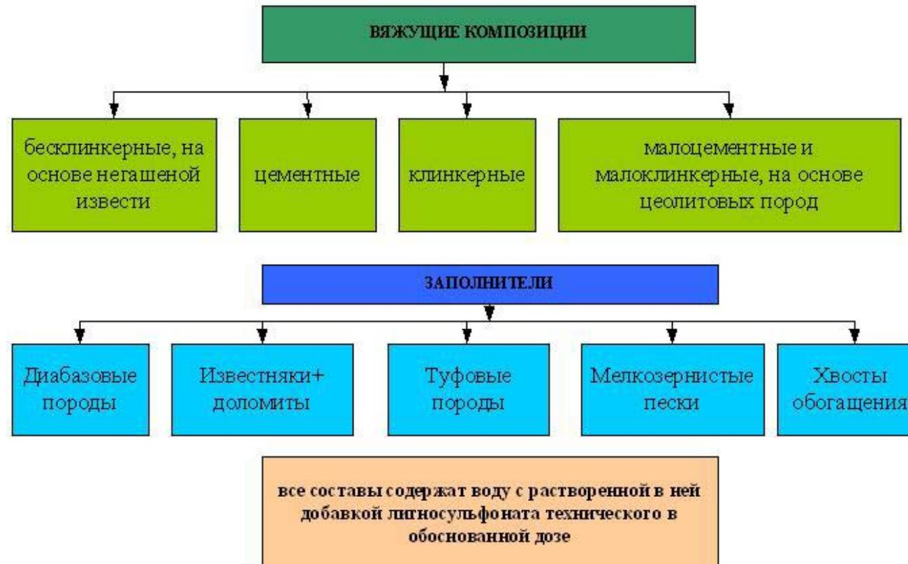
**Рис. 6. Разработанные составы закладочных смесей для алмазодобывающих рудников Якутии**
