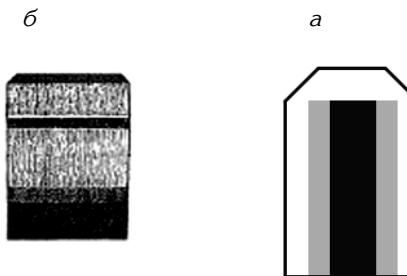
**Рис. 2. Концентрическая зональность:** а – продольный разрез кристалла, б – поперечный разрез кристалла
