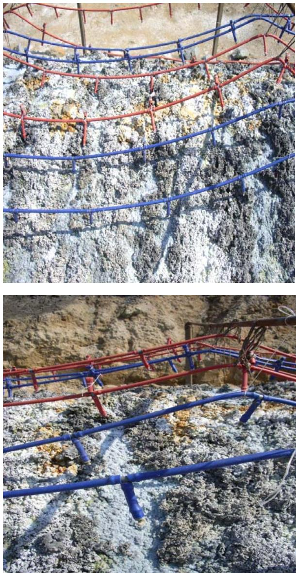
**Рис. 4. Внешний вид оросительной системы, расположенной по поверхности штабеля**
