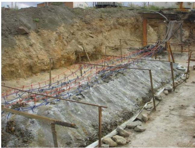
**Рис. 3. Внешний вид штабеля кучного выщелачивания**
