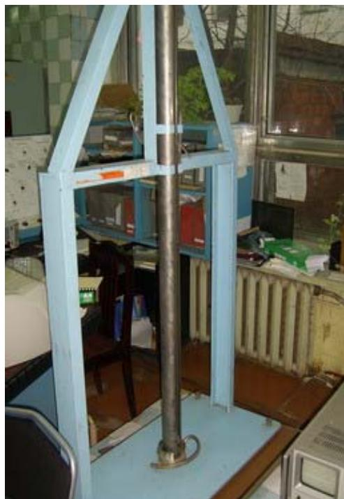
**Рис. 4. Ударная установка**
