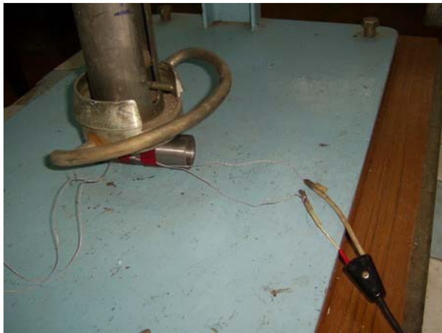
**Рис. 5. Испытуемый образец под ударной установкой, подсоединененный к осциллографу**
