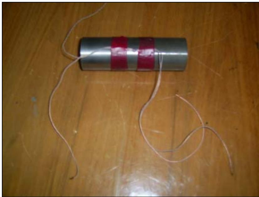
**Рис. 3. Анемометрический канал с проводами, подсоединенными к пьезокерамическим кольцам**
