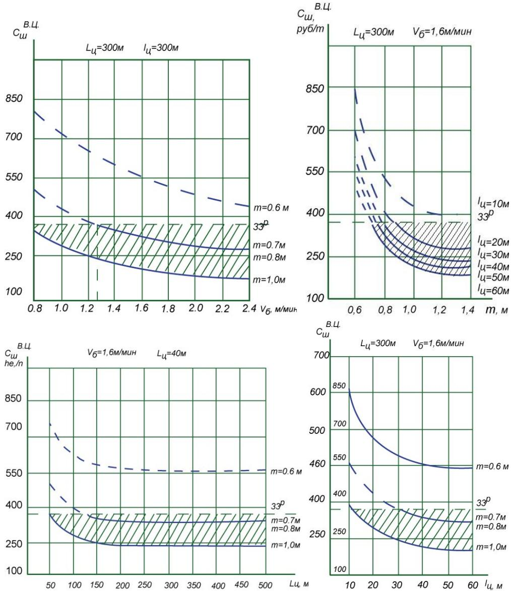
**Рис. 1. Зависимости затрат  $C_{ш}^{В.Ц.}$ , отнесенных к 1т выемки запасов угля из целиков от скорости бурения скважин  $V_б$ , от ширины целика  $I_у$ , от мощности пласта  $m$  и длины целика  $L_у$  бурошнековым комплексом безлюдной выемки КБВ «Вектор»:** – экономически целесообразная область выемки целиков ГИАБ
