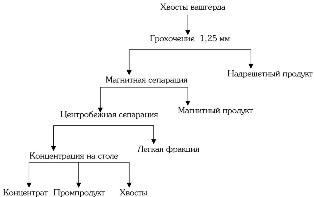
**Рис. 1. Технологическая схема переработки хвостов вашгерда**
