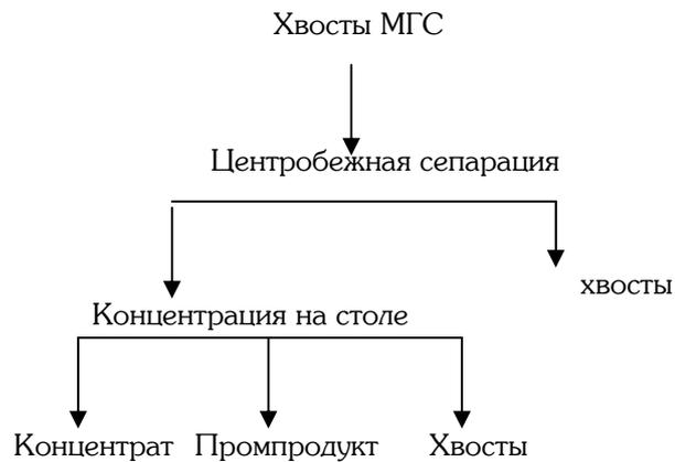
**Рис. 2. Технологическая схема переработки Хвостов МГС**
