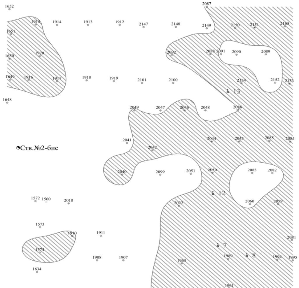
**Прогнозная карта зон, опасных по ГДЯ из почвы горных выработок, при комбайновой отработке карналлитового пласта В для условий рудника СКРУ-1 ОАО «Сильвинит»**
