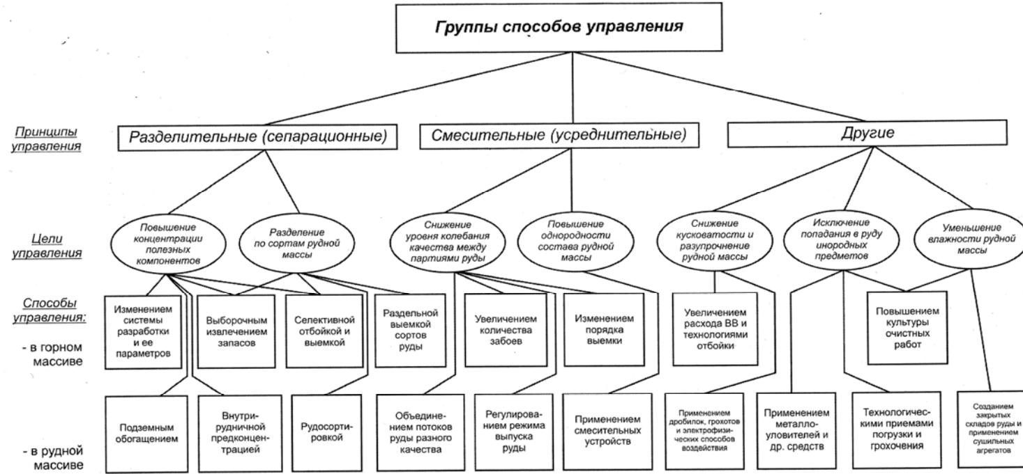
**Рис. 1. Систематизация способов управления качеством руды при подземной добыче**
