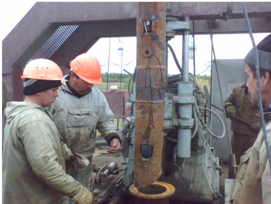
**Фото 2. Расположение трансдьюсера и датчика давления на добычном снаряде**
