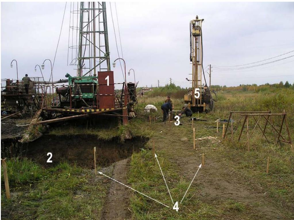
**Фото 1. Геофизические исследования методом СПШ:** 1 – добывчной агрегат производящий отработку скважины; 2 – провал ранее отработанной скважины; 3 – работа с аппаратурой СШП; 4 - точки измерений методом СШП; 5 – буровая установка УРБ-2А2, для бурения контрольных скважин
