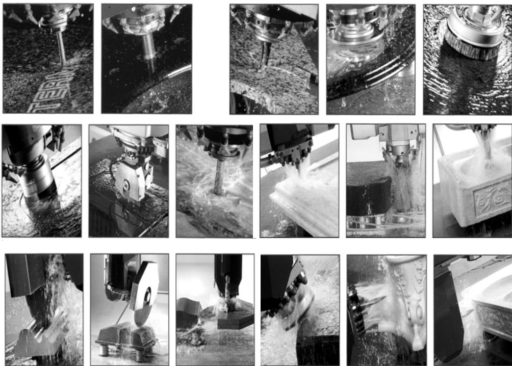
**Рис. 2. Типовые технологические операции и инструментальные переходы, выполняемые на камнеобрабатывающем многоцелевом станке с ЧПУ**
