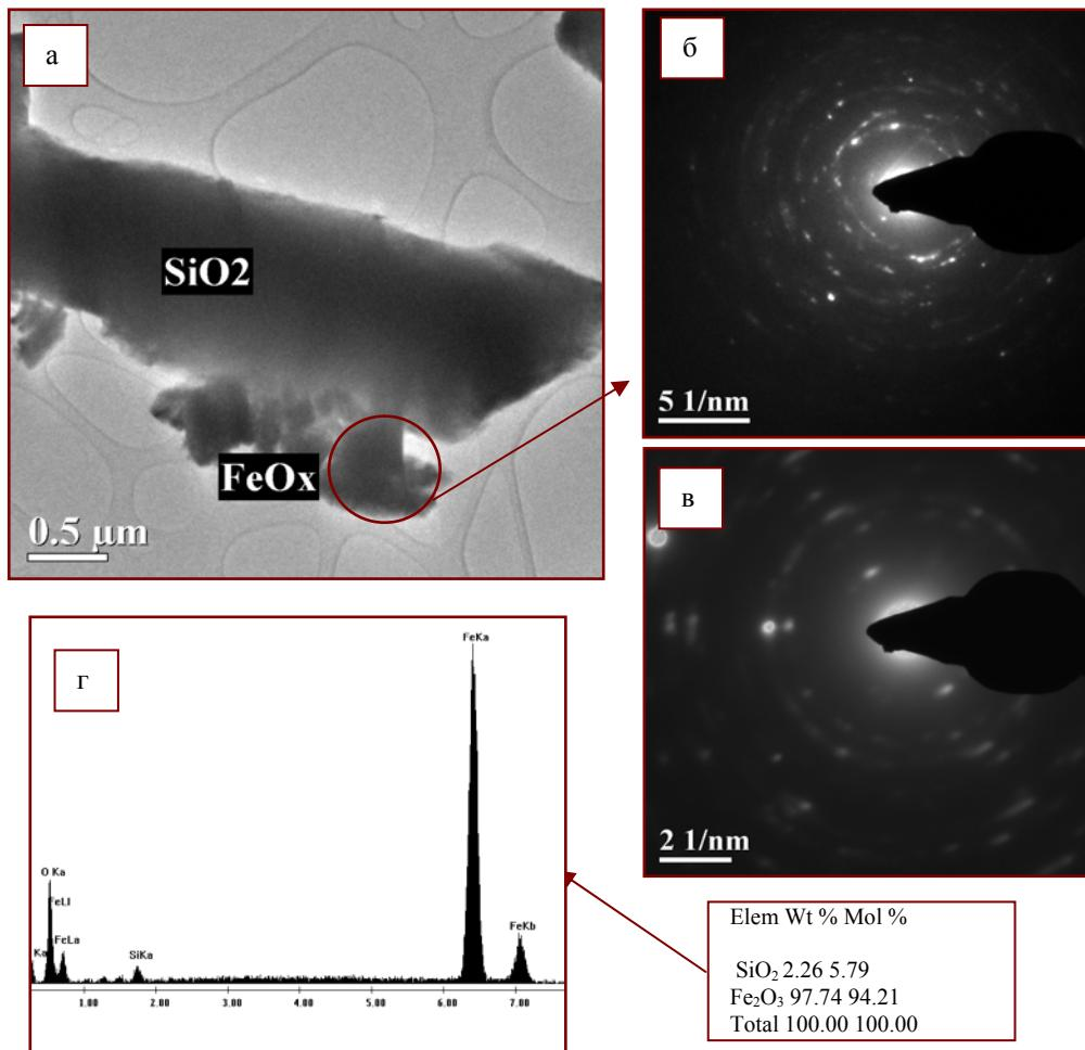
**Электронограммы фаз, снятые с частиц магнетита под разными углами ориентировки прибора (рефлексы соответствуют структуре магнетита):** а – диспергированный материал на подложке: частицы оксида железа, силиката, кремния; б, в – картины микродифракции от частиц магнетита; г – энергодисперсионный спектр и химический состав частицы магнетита (примесь SiO<sub>2</sub> связана с наличием наноразмерных включений)
