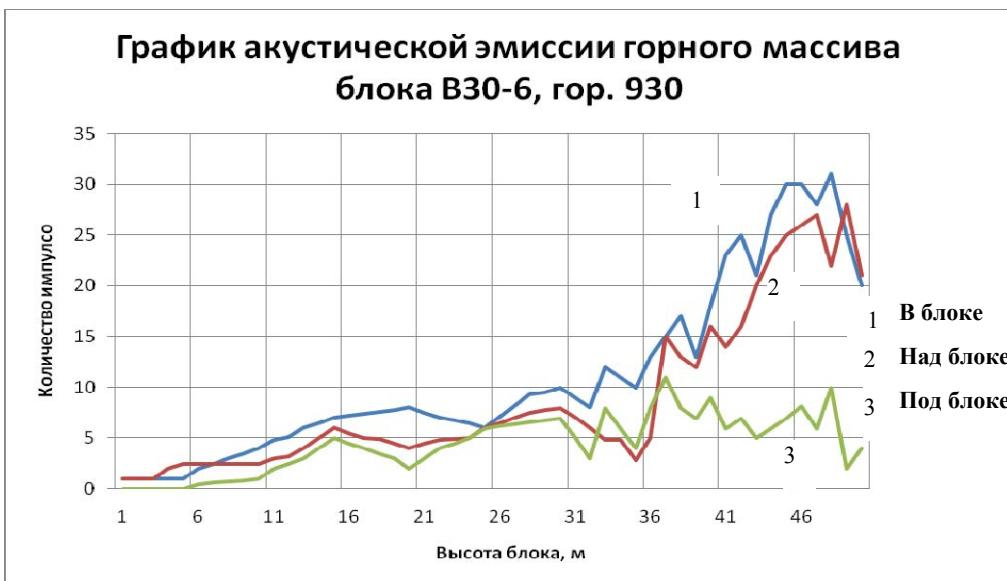
Как видно из графика, акустическая эмиссия массива имеет 3 характерные кривые. Эмиссия массива над блоком начинала резко возрастать с поднятия высоты отбойки до 40 м и оставшейся к отбойке нетронутого массива порядка 10 м. объясняет рост акустической эмиссии массива в блоке можно постоянным увеличением воздействия взрывных работ на оставшийся целик. Исходя из понятия, что касательное напряжение
