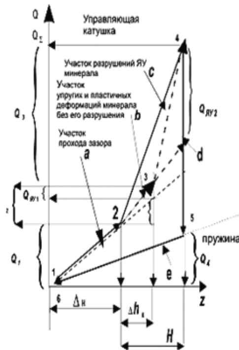
Рис. 3. Энергетические передаточные характеристики Q = f(z) при гравировании минерала однокатушечным преобразователем
