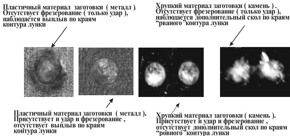
Рис. 1. Лунки, получаемые при гравировании и УМФ на пластичных и хрупких материалах
