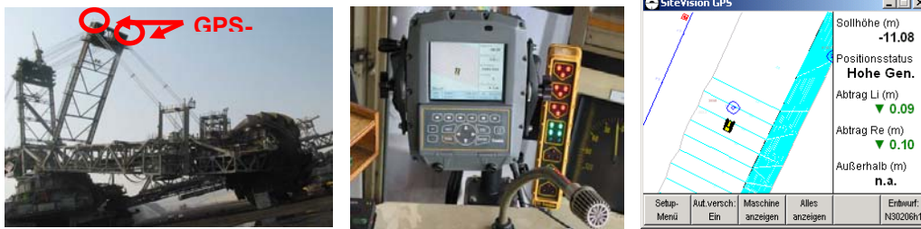
Рис. 7: SABAS, состоит из GPS антенн и другого аппаратного обеспечения Hardware/Сенсоры (слева и в середине), также помощи в управлении баггером (справа,)перманентное сравнение актуальной и запланированной позиции
