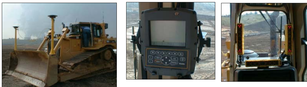
Рис. 10: Машинная контрольная система, состоящая из бульдозера с 2 GPS антеннами (слева, устройство для ввода и вывода (середина) световые палочки для навигации экрана (справа)
