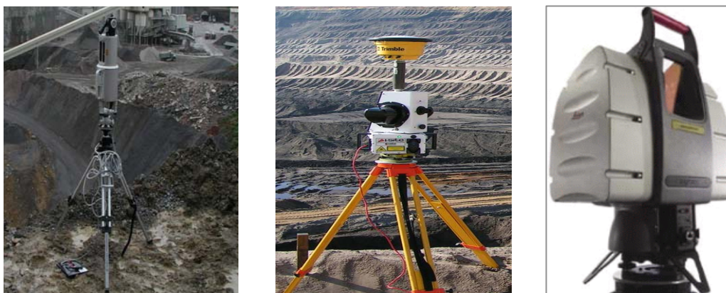
Рис. 13. Применимый лазерный сканер для съемки открытой разработки; Riegl Z420i (слева), Maptek I-SiTE 4400 (середина) und Leica HDS 3000 (справа)
