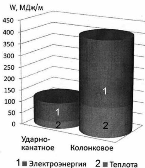
**Рис. 2. Энергетический баланс буровых установок ударно-канатного и колонкового бурения**
