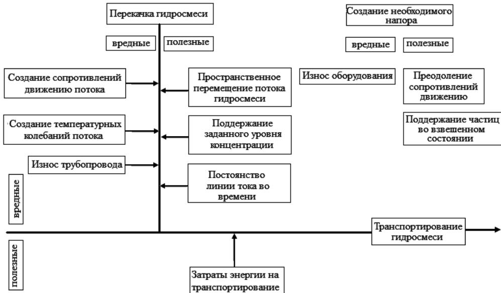
шинство энергозатрат при перекачке пульпы. За реализацию этих функций отвечает трубопровод(магистраль) гидротранспортной установки.
