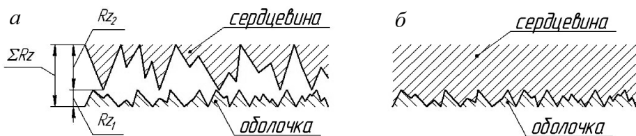
Рис. 5. Поверхность контакта в биметаллической паре до (а) и после (б) пластической деформации в результате нагрева
