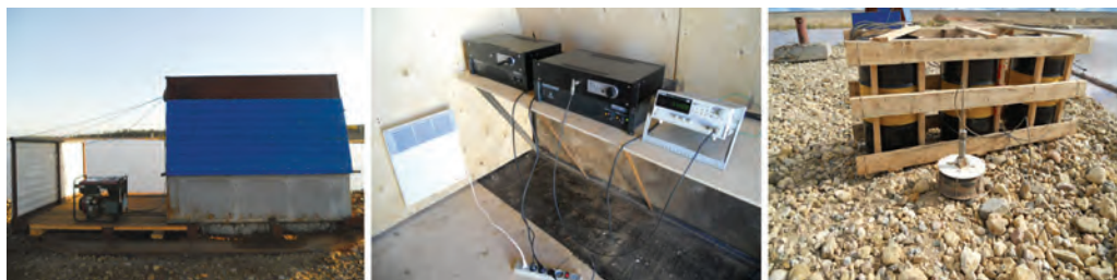
Рис. 2. Элементы стационарного модуля акустической установки: а) внешний вид помещения, б) внутренний вид помещения, в) плот с излучателем
