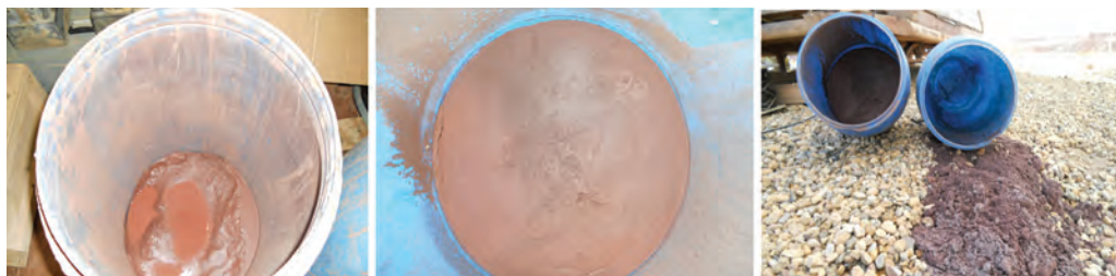
Рис. 7. Результаты испытаний по акустическому сгущению осадка: а) после слива пульпы, б) перед измерениями, в) удаление осадка
