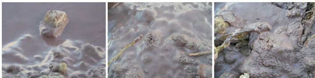
Рис. 6. Внешний вид сапонитсодержащего осадка: а) частично погруженный камень, б) дно карты намыва, в) фрагмент дна карты
