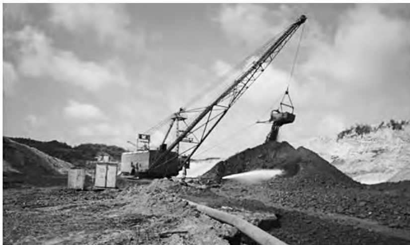
Рис. 1. Экскаваторное рыхление янтароносного пласта перед гидромониторным размывом
