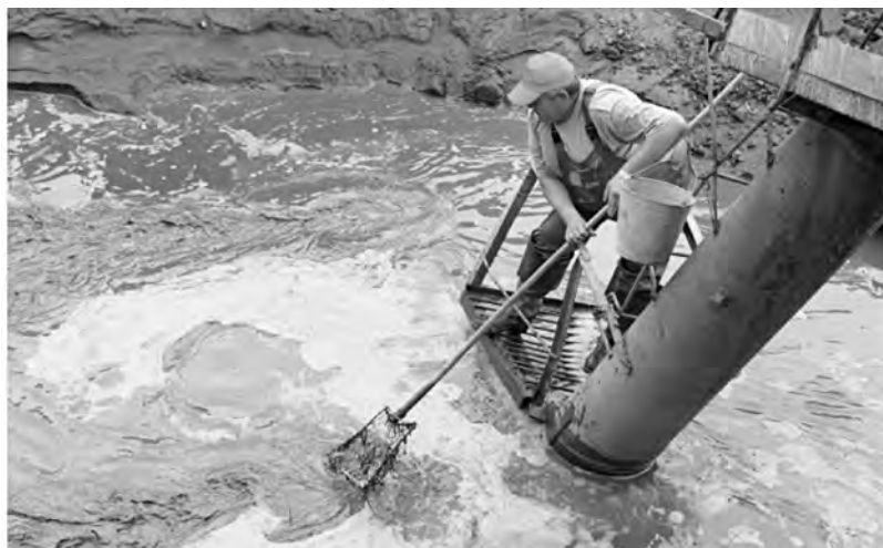
Рис. 3. Вылавливание янтаря сачком из зумпфа с целью исключения его попадания во всас землесоса
