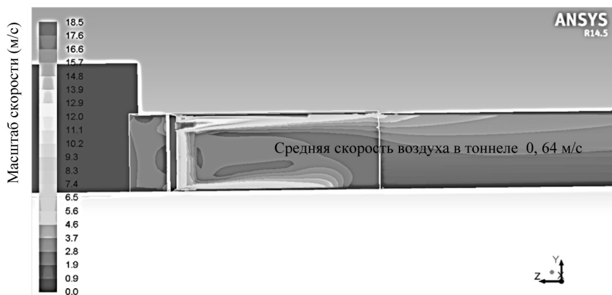
Рис. 3. Распределение скорости воздуха в сечении, прилегающем к вентиляционным воротам у западного портала при значении естественной тяги 400 Па
