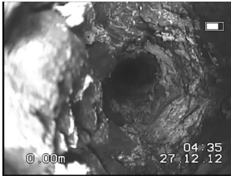
Рис. 5. Определение границ деформирования скважины с помощью алгоритма поиска границ
