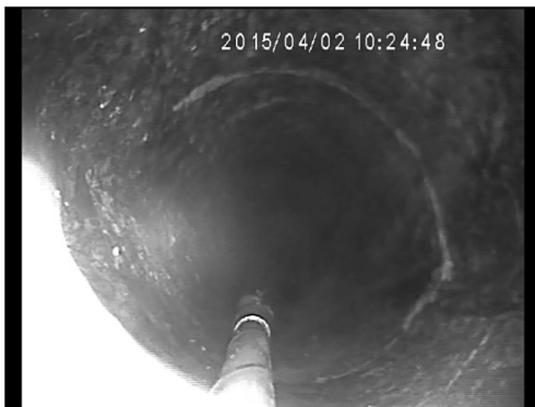
Рис. 1. Деформируемая скважина диаметром 105 мм
