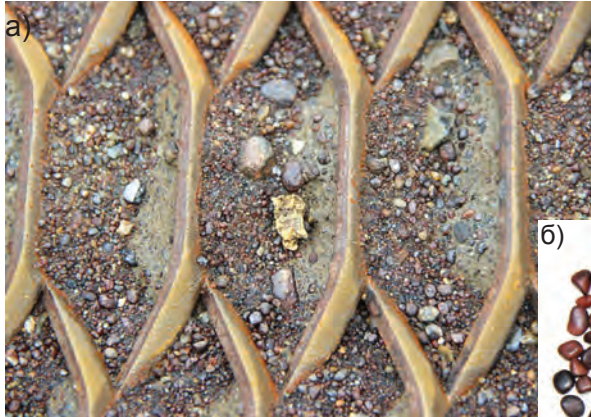
Рис. 2. Отсадочная установка с тяжелой фракцией, содержащей золото и деревянистое олово (а), галечки деревянистого олова, 1–2,5 см по длинной оси (б) Fig. 2. Jigging machine with sink bearing gold and wood tin (a), wood tin gravels 1–2.5 cm in size along longer axis (b)
