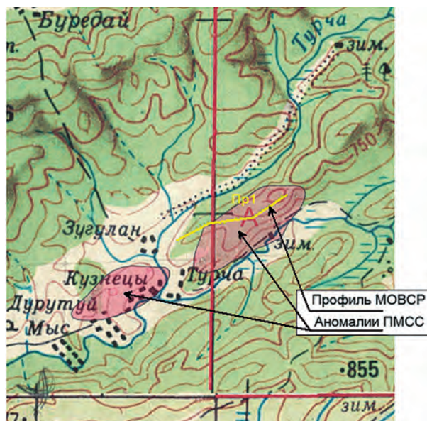
Рис. 4. Карта участка исследования с пунктами измерений по МСП и аномалиями ПМСС Fig. 4. Study site map with the multichannel seismic profiling points and anomalies
