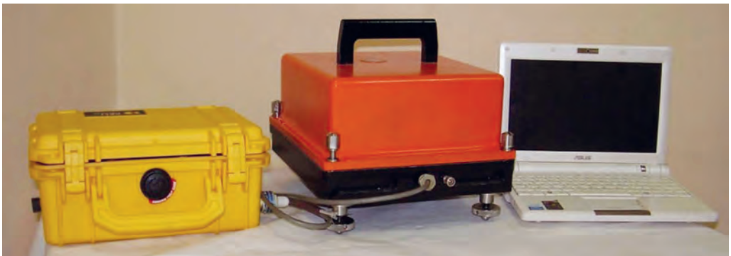
Рис. 2. Широкополосная трехкомпонентная сейсмостанция на базе датчика SM 5 и регистратора «Экспресс МСП» Fig. 2. Wideband three-component seismic station on the basis of sensor SM-5 and recorder Express-MSP
