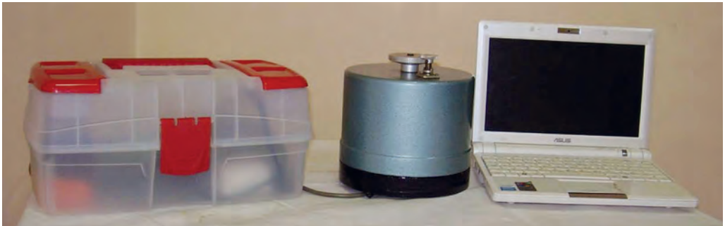
Рис. 1. Однокомпонентная станция на базе датчика SM-6 и регистратора «Экспресс Т» Fig. 1. One-component station on the basis of sensor SM-6 and recorder Express-T
