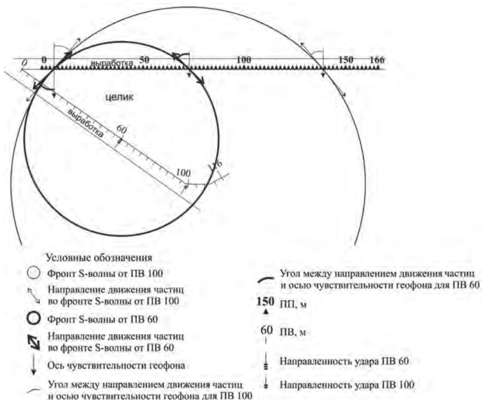
Рис. 2. Схема опытных работ по сейсмическому просвечиванию Fig. 2. Diagram of experimental works on seismic survey
