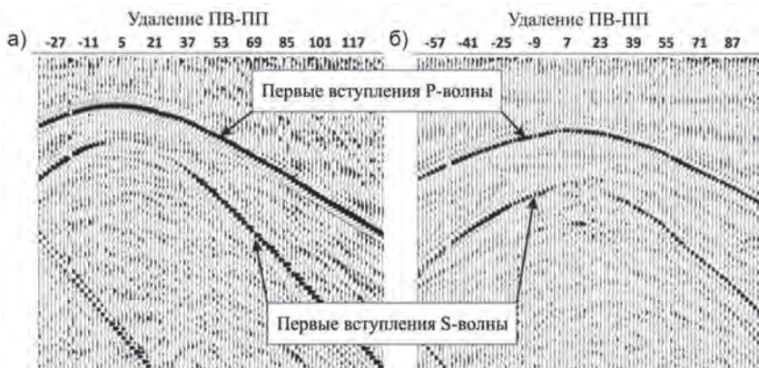
Рис. 3. Примеры сейсмограмм просвечивания: для ПВ 60 м (а) и 100 м (б) Fig. 3. Examples of seismic records: for source point 60 m (a) and 100 m (b)
