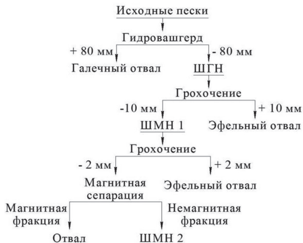
Рис. 4. Схема обогащения исходных песков с магнитной сепарацией Fig. 4. The scheme of the sands enrichment with magnetic separation
