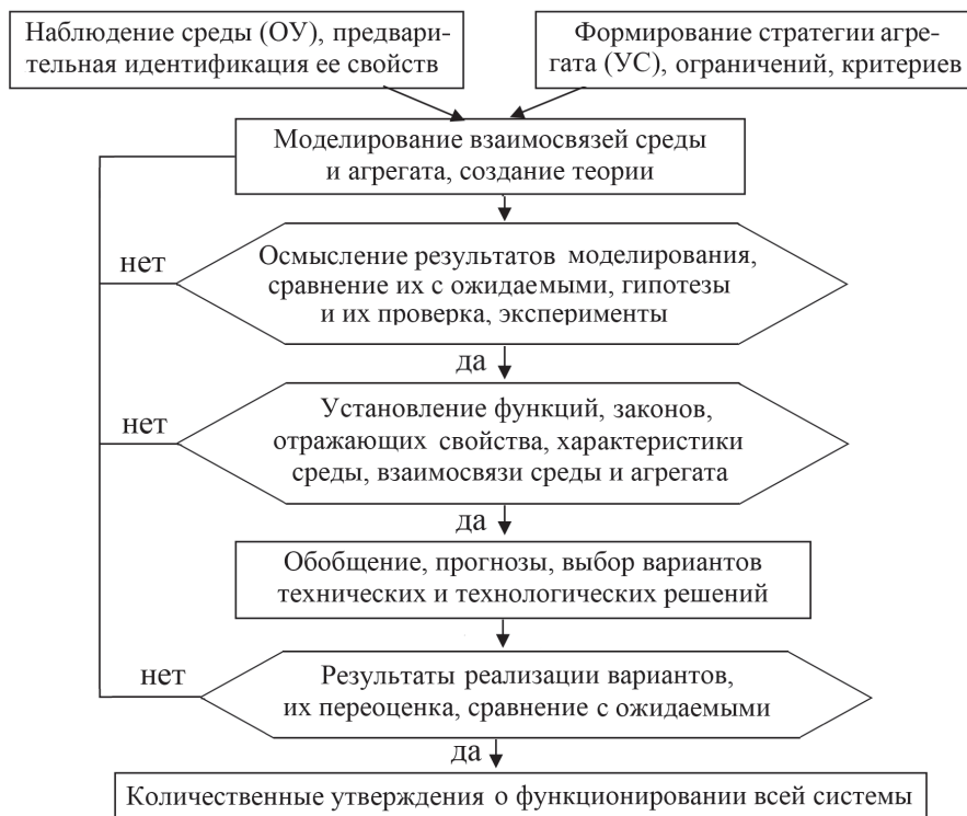
Интерактивная схема адаптации агрегата и среды Interactive chart of machine-and-operating environment adaptation
