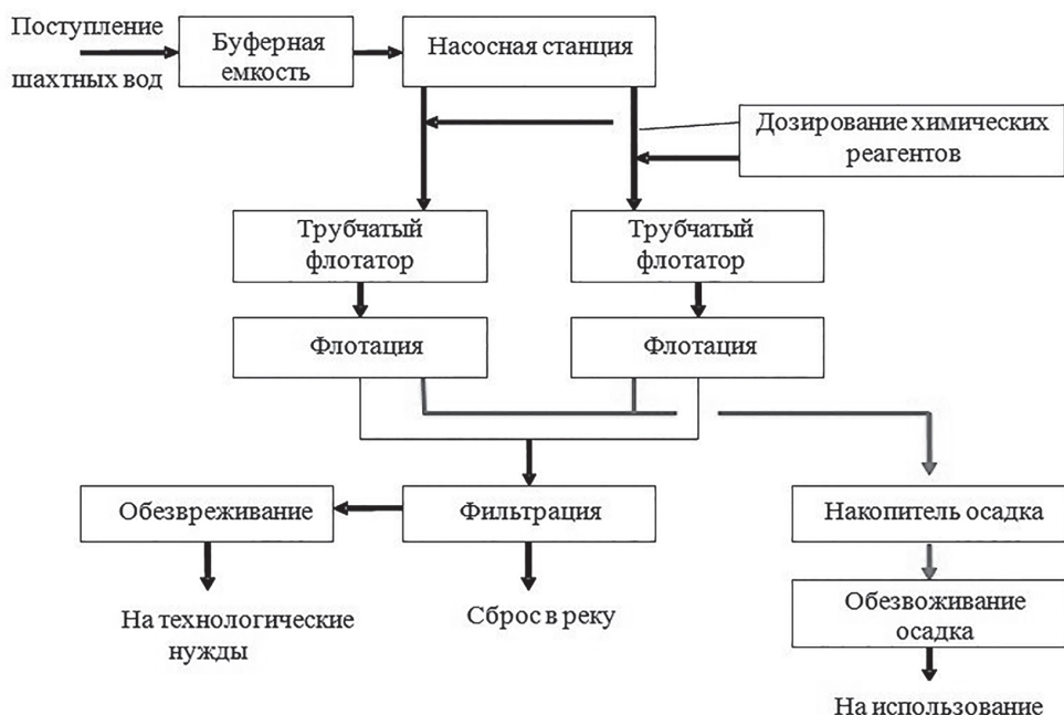
Технологическая схема очистки шахтных вод Technological scheme of mine water treatment
