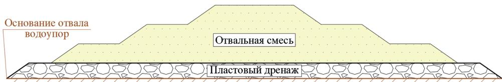
Рис. 3. Схема пластового дренажа в основании отвала
