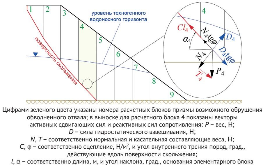
Рис. 1. Схема к расчету устойчивости обводненного откоса
