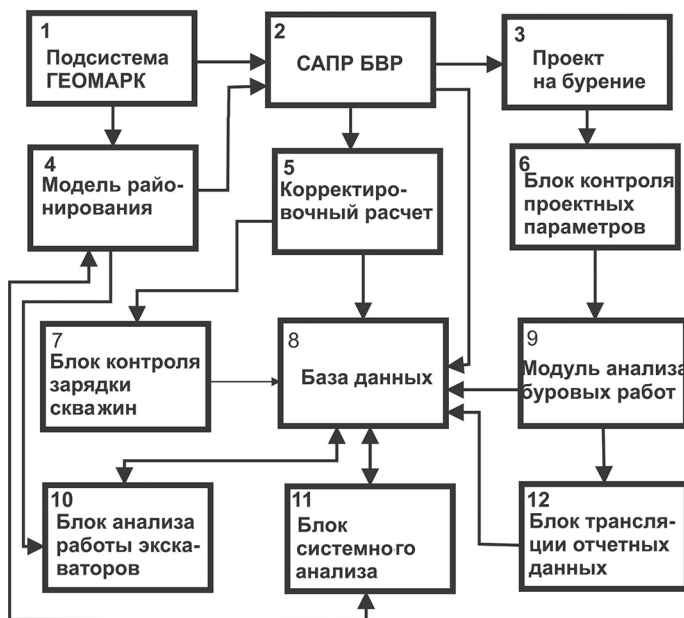
Рис. 3. Система объективного мониторинга и управления геомеханическим обеспечением процессов горных работ Fig. 3. The system of objective monitoring and management of geomechanical support of mining processes
