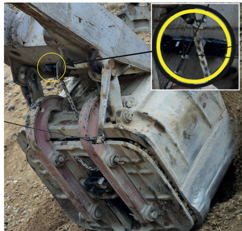
Рис. 4. Модуль технологического анализа процесса экскавации, закрепленный на конце рукояти ковша
