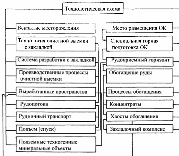
Принципиальная структура типовой технологической схемы разработки рудных месторождений на базе подземных горно-обогатительных комплексов с закладкой выработанных пространств. ОК – обогатительный комплекс
