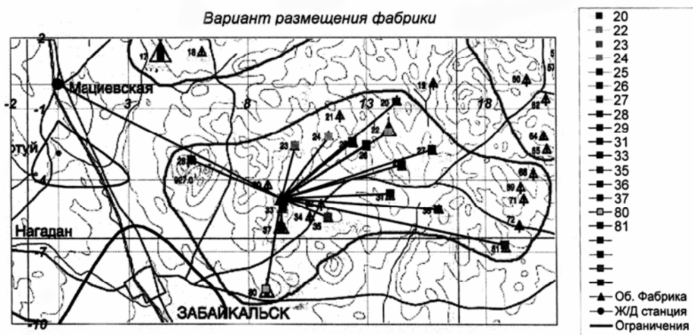
Рис. 2. Схема размещения обогатительной фабрики для обработки мелких флюоритовых месторождений Бугутурского рудного поля
