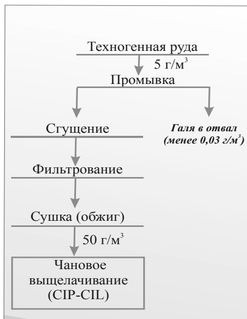
Рис. 5. Схема установки для извлечения золота
