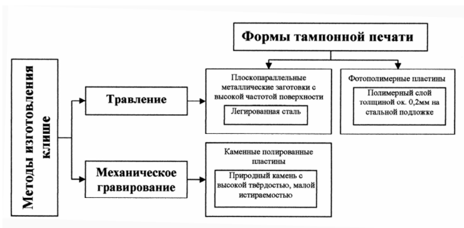
Рис. 1. Методы и материалы для изготовления клише в тампонной печати.
