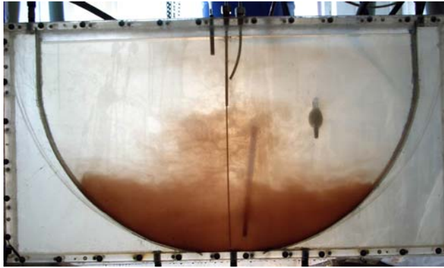
Рис. 2. Ввод и движение нерастворимых включений в модельной емкости
