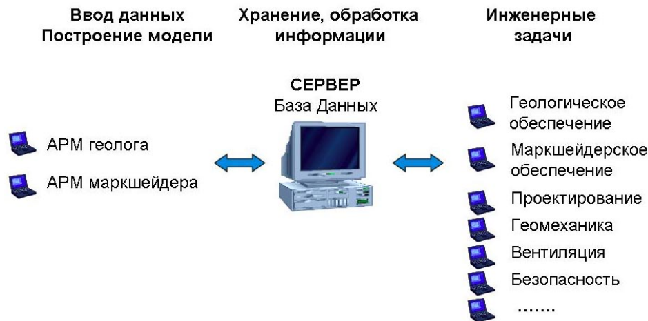
Рис. 1. Функциональная схема комплекса компьютерных программ для горнодобывающего предприятия
