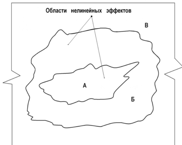
Рис. 2. Зональность состояния массива горных пород после горного удара или техногенного землетрясения: А – очаг горного удара, зона разрушения горных пород; Б – зона наведённой трещиноватости; В – природное состояние среды
