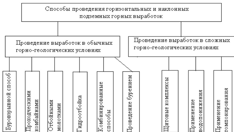
**Рис. 1. Существующие технологии проведения горизонтальных и наклонных подземных горных выработок**
