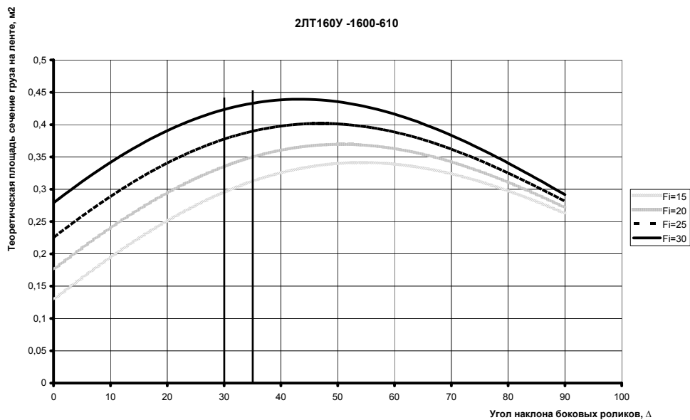
Рис. 5. График зависимости теоретической площади сечения груза F на ленте конвейера 2ЛТ160У, от угла наклона боковых роликов при заданном угле естественного откоса груза в движении \varphi , при длине роликов l_p = 610 мм.
